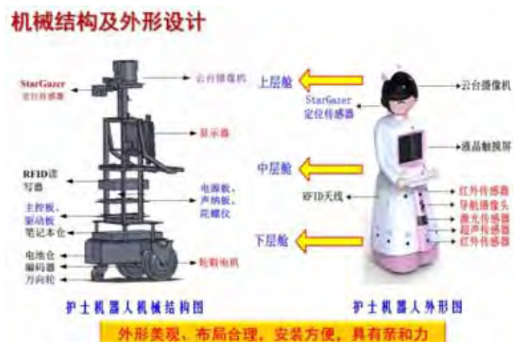
图 1 巡视机器人机械结构和外形设计
