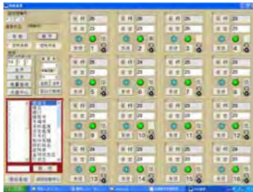
中央空调远程监控界面
